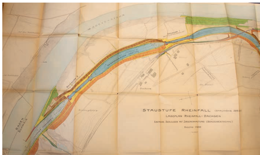
Unterer Vorhafen, 1. Schleuse, Zwischenbecken, 2. Schleuse und offener Kanal
