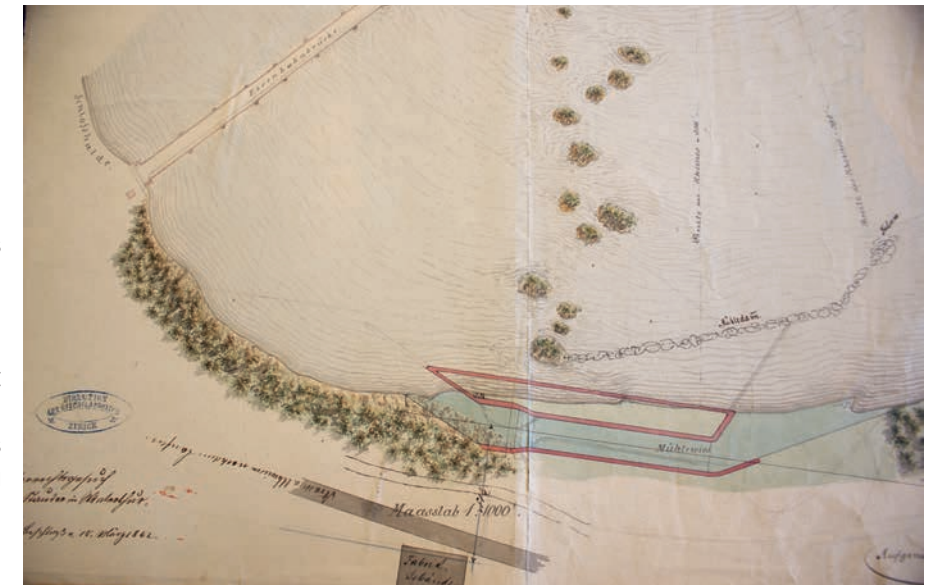
Plan Projekt J.J. Stauder von 1862. Stauder wollte, analog der Transmissionsanlage bei Furlingen, die Wasserkraft für eine auf der benachbarten Anhöhe noch zu bauenden Spinnerei nutzen.
